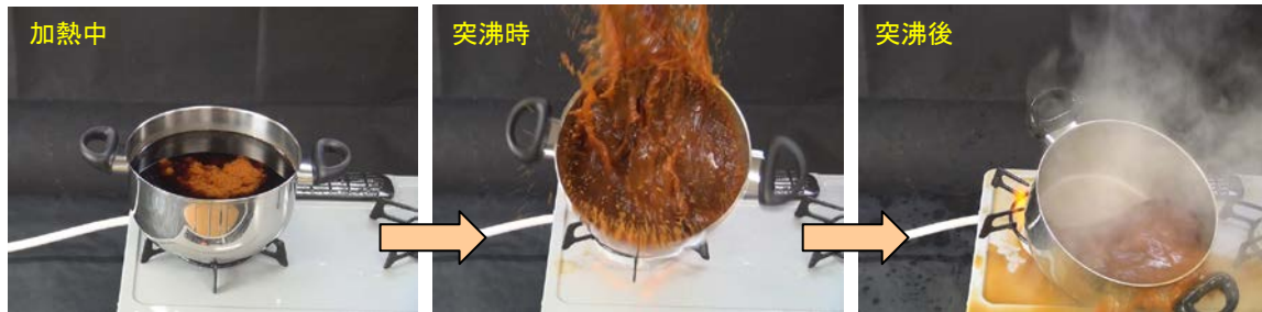
写真5. ガスコンロ使用時に起きたみそ汁の突沸
