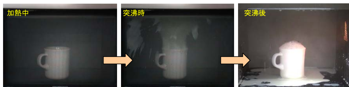
写真2. 電子レンジ使用時に起きた豆乳の突沸
