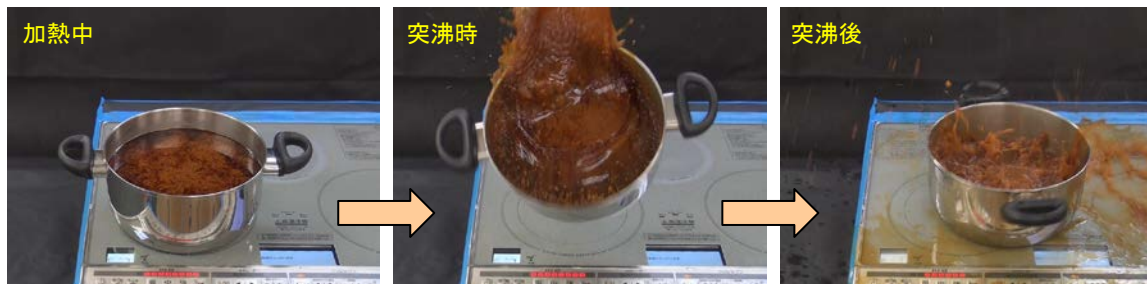
写真6. IH クッキングヒーター使用時に起きたみそ汁の突沸
